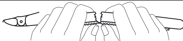
Abb. 2.1 Das Diffusionsröhrchen wird an der Brechsicke gebrochen (roter Punkt ist im unbedeckten Teil des Halters sichtbar). Der Halter schützt die Hände vor Glassplittern Fig. 2.1 The diffusion tube is broken at the breaking bead (red dot is visible in the uncovered part of the holder). The holder protects the hands from glass splinters
